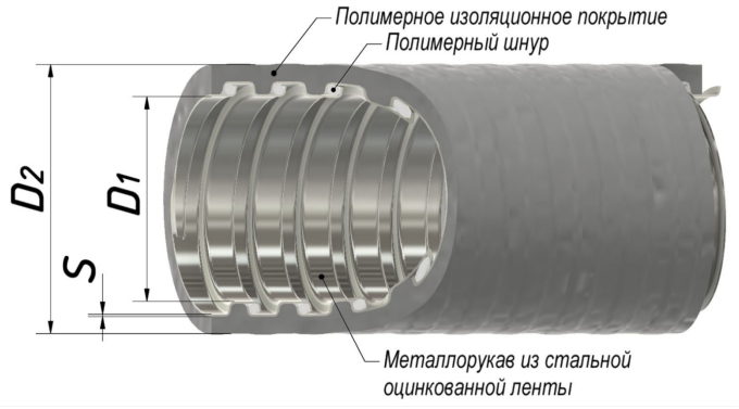
Рисунок 1. Металлорукав типа МПГ нг серый с протяжкой
