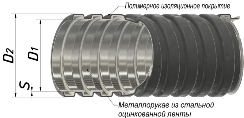
Рисунок 1. Металлорукав типа РЗ-ЦПнг
