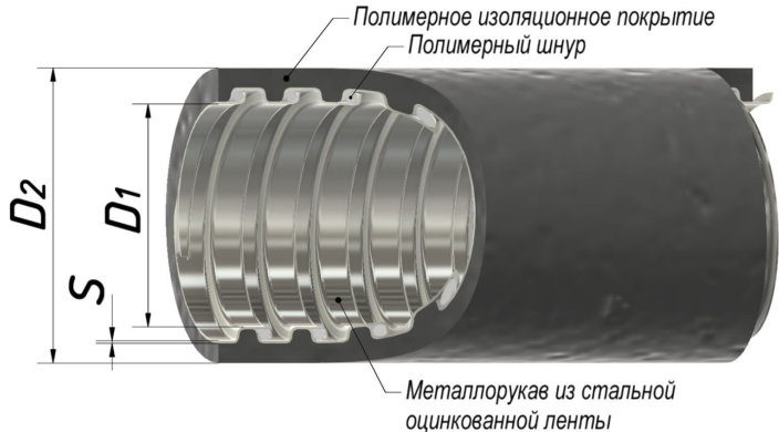
Рисунок 1. Металлорукав типа МПГ нг черный
