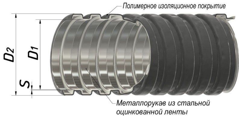
Рисунок 1. Металлорукав типа МРПИ нг морозостойкий с протяжкой
