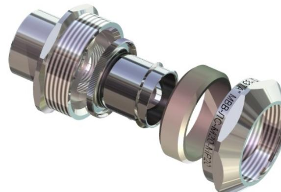
2.1 Муфты МВВ является трубной арматурой для герметичного и надёжного соединения частей гибкой гофрированной металлической или композитной трубной системы и жёсткой резьбовой металлической трубной системы прокладки кабелей по ГОСТ Р МЭК 61386.1-2014 (то есть для соединения металлорукава типов МРПИ, МПГ, ШЭМ, РЗ-Ц, РЗ-ЦХ, РЗ-ЦА, РЗ-ЦП или других с резьбовой металлической трубой по ГОСТ 3262-75 или фитингом с наружной резьбой для целей прокладки кабелей).
