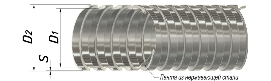
Рисунок 1. Металлорукав типа P3-H
