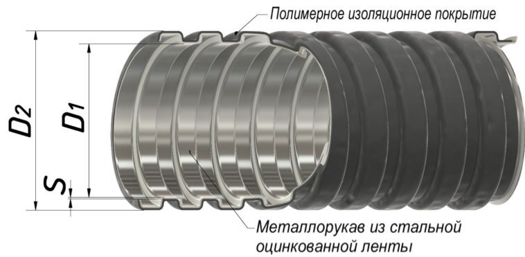
Рисунок 1. Металлорукав типа РЗ-ЦП нг-LS с протяжкой
