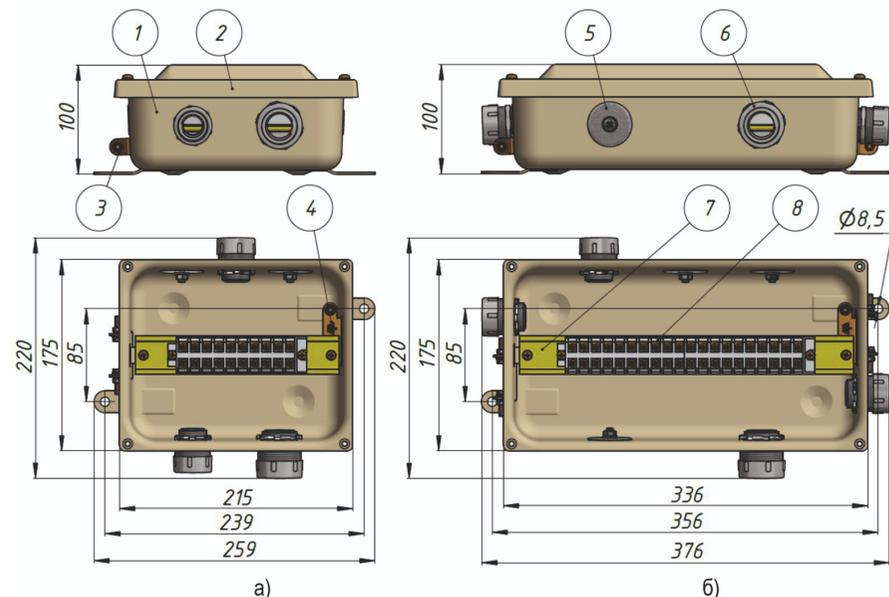
Рисунок 1 — Комплектация клеммных коробок (с установленными фитингами):
