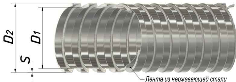
Рисунок 1. Металлорукав типа P3-H
