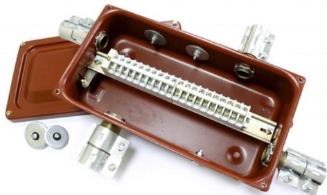
Коробки клеммные ККМТ и ККМА предназначены для соединения и разветвления электрических силовых и контрольных кабелей как силовых цепей, так и цепей КИПиА, проложенных в металлических трубах (в трубной системе электропроводки). Присоединение металлических труб производится с помощью вводных патрубков и муфт ТР у коробок ККМТ; и муфт АТК у коробок ККМА.
