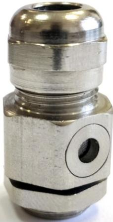
Кабельные вводы с системой вентиляции, совмещают в себе ввод и элемент выравнивания давления. Вводы такого типа производятся из латуни с никелевым покрытием.
