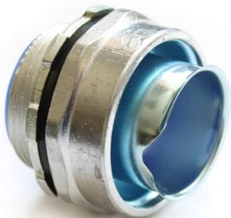
Муфта вводная МВ (без накидной гайки) предназначена для ввода металлорукава или металлорукава в пвх в оболочки электрооборудования. Состоит из цапающей заземляющей гайки, уплотнителя, корпуса, оконцевателя (впрессованного в корпус).
