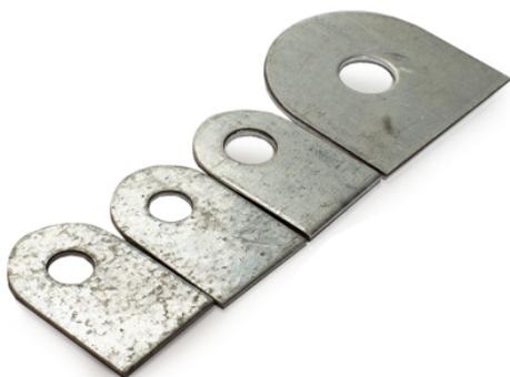
Флажок Ф используется для присоединения перемычки ПГС, или любого другого заземляющего проводника к оборудованию. Флажок заземления крепится сваркой к корпусу оборудования. Материал изготовления: сталь с оцинкованным покрытием.
