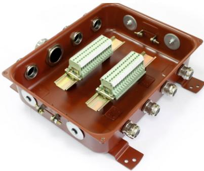
Коробки клеммные КС-30 и КС-40 предназначены для соединения и разветвления силовых электрических цепей и цепей КИПиА, выполняемых контрольными и силовыми кабелями с алюминиевыми или медными жилами сечением до 4 мм<sup>2</sup>. В коробке используются металлические или пластмассовые кабельные вводы.
